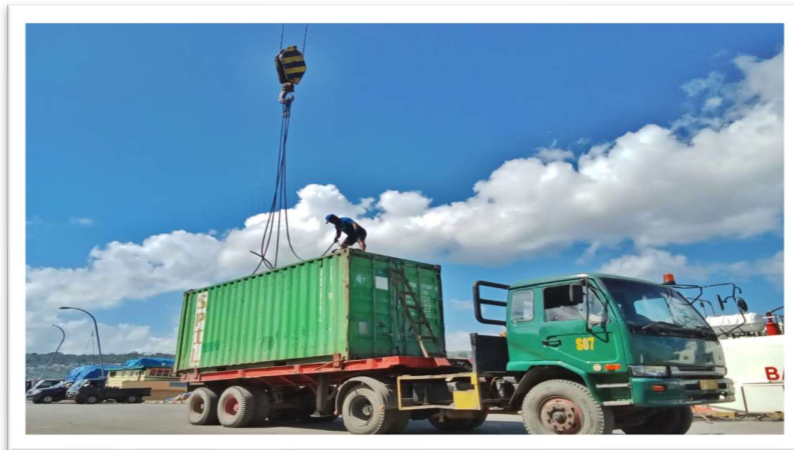
Gambar 5. Pelepasan Sling (Sumber : Dokumentasi Pribadi 2025)
