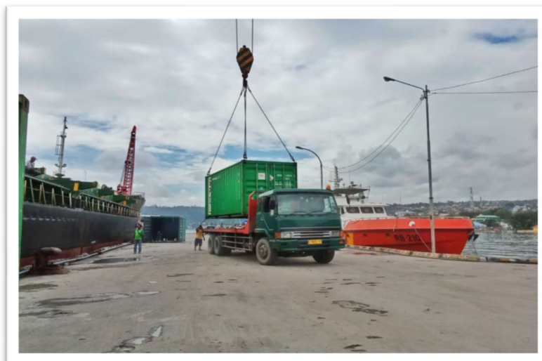
Gambar 4. Penurunan Container ke Tractor Trailer (Sumber : Dokumentasi Pribadi 2025)
